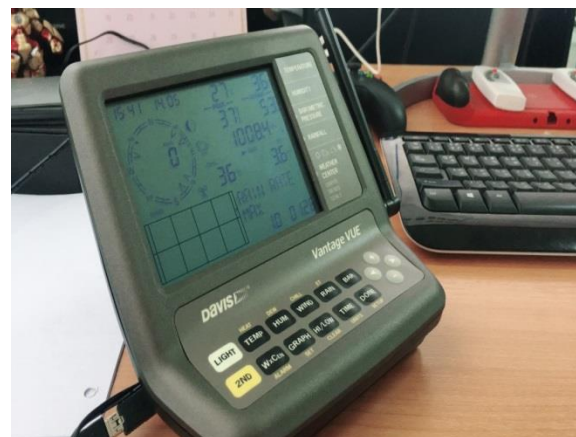
รูปที่ 5.2.1 – 2 อุปกรณ์เครื่องมือตรวจวัดอุตุนิยมวิทยา (น้ำฝน ความเร็วลม อุณหภูมิ ความกดอากาศ และความชื้นสัมพัทธ์)
